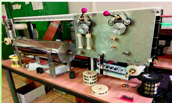
Instalație de tratament termo-mecanic în flux continuu a firelor magnetice amorfice.
